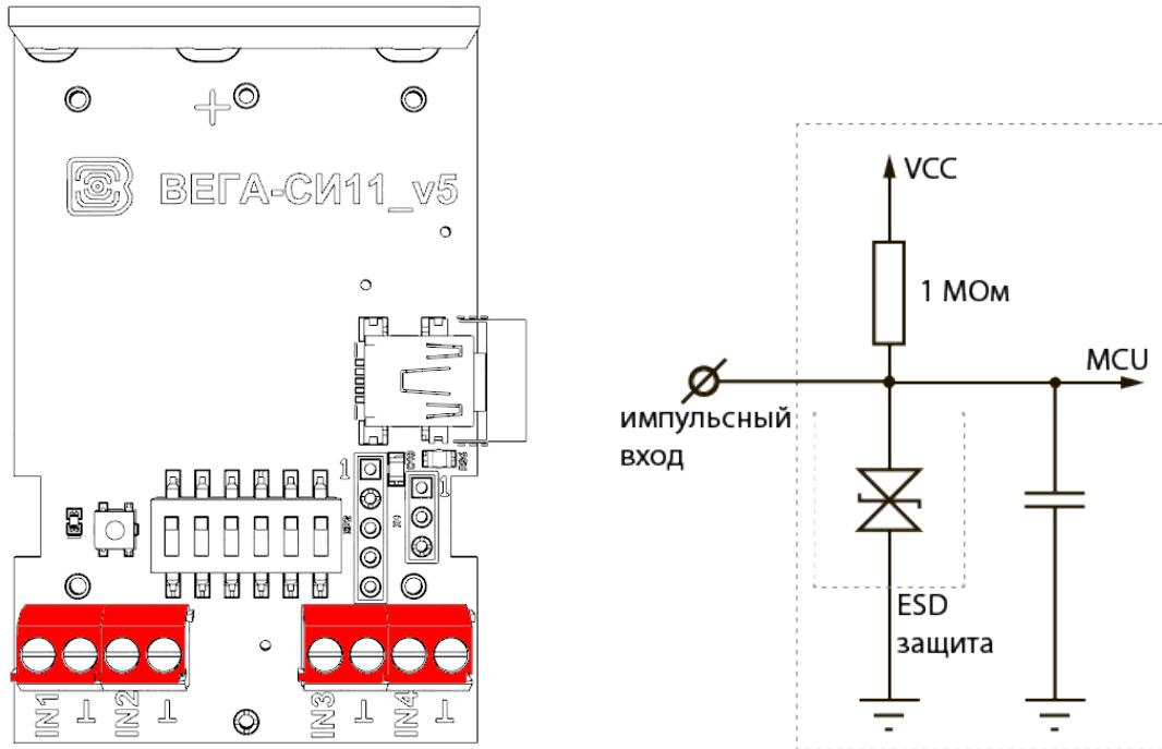
Счетчик импульсов оснащен алгоритмом антидребезга с постоянной времени 5 мс. Подсчет импульсов осуществляется для частот до 200 Гц.
